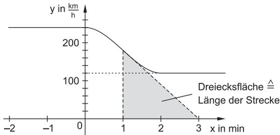
Die zwischen 15:01 Uhr bis zum Stillstand bei konstanter Abnahme der Geschwindigkeit zurückgelegte Streckenlänge  $\ell_0$  ergibt sich über die Dreiecksfläche (siehe Skizze):
