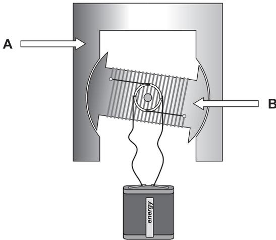
Abbildung 14: Elektromotor (© Conrad Electronic SE (bearbeitet))
