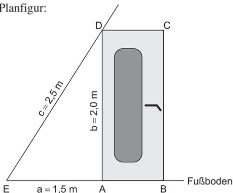
Die berechnete Größe für die Länge der Strecke  $\overline{DE}$  entspricht der gegebenen Größe. Die Tür steht somit rechtwinklig zum Fußboden.
